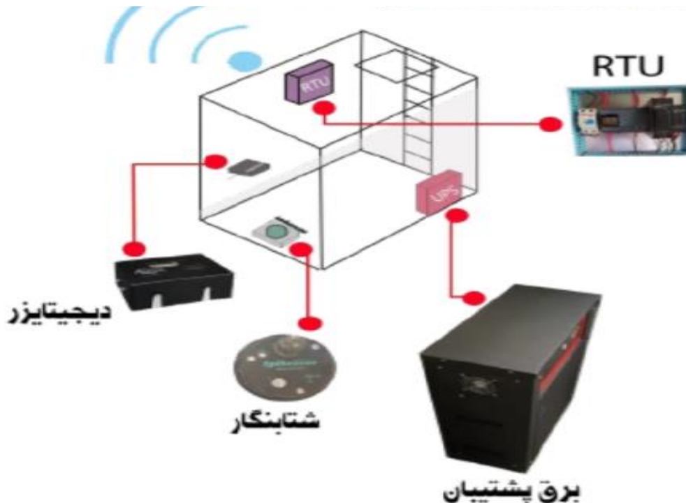
شکل ۲: جانمایی محل تجهیزات در اتاقک
