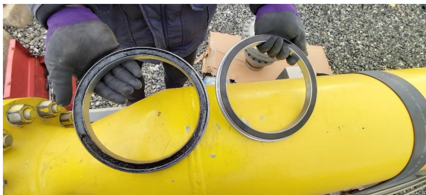
یک نمونه از نگهداری غیر اصولی از گسکت در فضای باز ایستگاه
