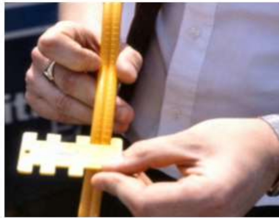
شکل شماره ۲: وسیله کنترل عرض بید (Bead)
