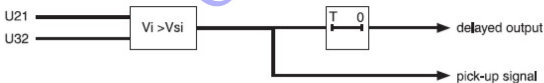
شکل ج-۳- بلوک دیاگرام حفاظت ولتاژی SEPAM80-47
