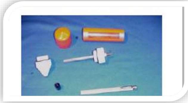
شکل ۱۲-۳ جداسازی قطعات نیم پیل
